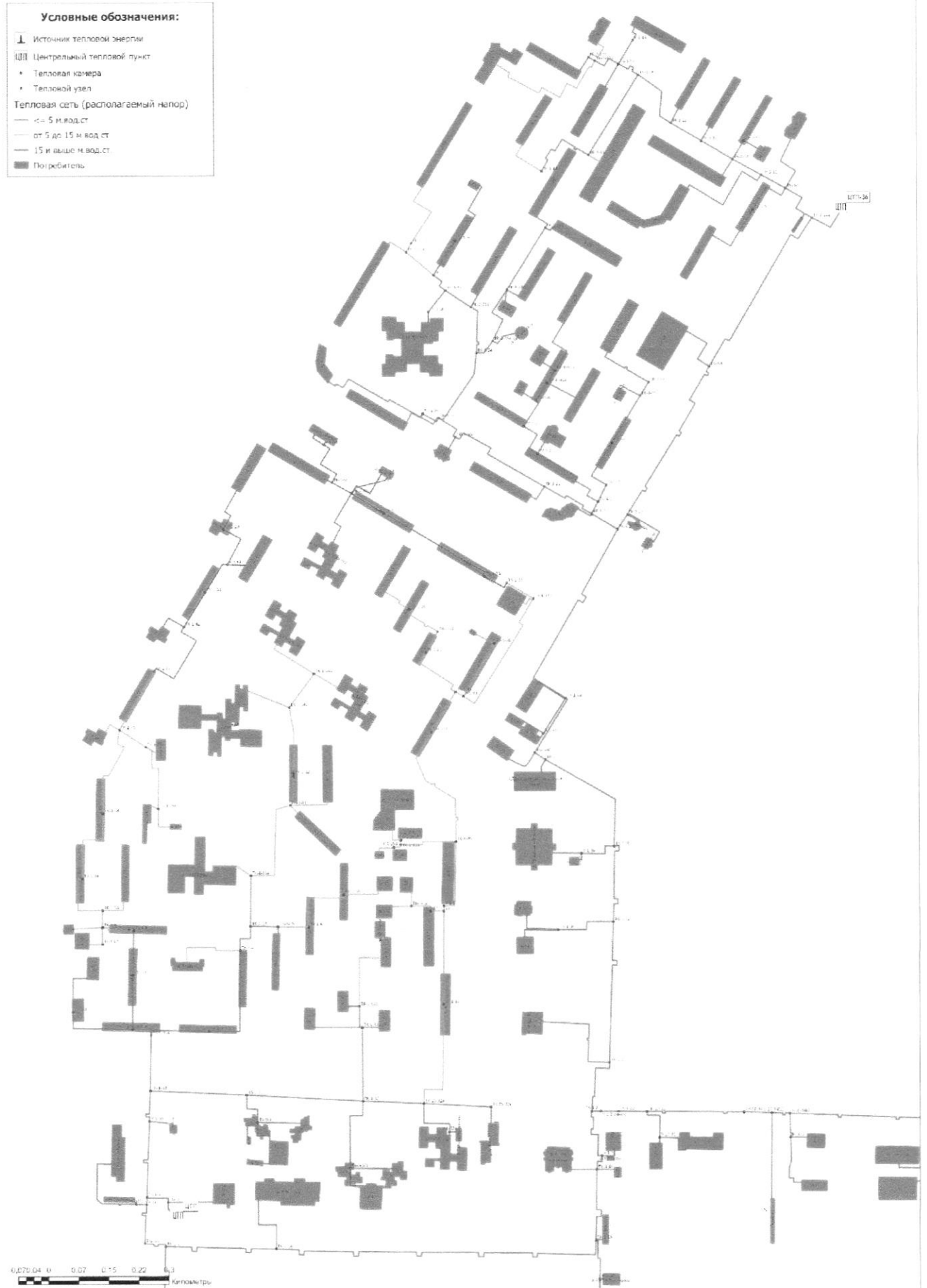
Рисунок 1.6.2.2 - Располагаемый напор на участках тепловых сетей ЗАТО город Радужный (квартал 1, 3, 9)
